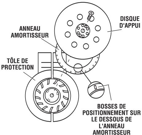
usé en le tirant fermement hors de la rainure de positionnement. Desserrez les deux vis de la toile de protection tout juste assez pour pouvoir séparer la toile de protection d'environ 1/4 de pouce. Alignez les bosses de positionnement de l'anneau amortisseur sur les découpages de la toile de protection et appuyez sur l'anneau avec les pouces jusqu'à ce que la toile de protection soit complètement calée dans la rainure autour de l'anneau, puis serrez les vis.
