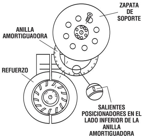
hasta sacarla de la ranura posicionadora. Afloje los dos tornillos del refuerzo justo lo suficiente para poder separar dicho refuerzo aproximadamente 1/4 de pulgada. Alinee los salientes posicionadores de la anilla amortiguadora con los cortes de abertura del refuerzo y presione la anilla con los pulgares hasta que el refuerzo se asiente en la ranura completamente alrededor de la anilla. A continuación, apriete los tornillos.
